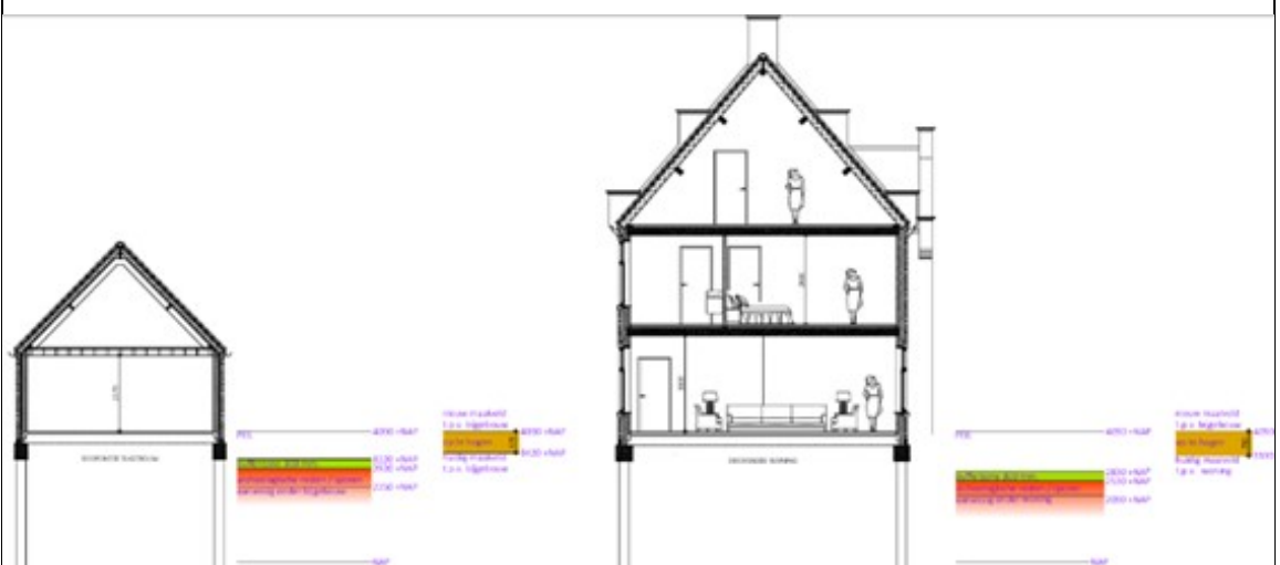
Afbeelding 1. Doorsnede tekening van stal en woning met aangegeven de bufferlaag (met groen aangegeven) ter bescherming van het archeologische nivo (in rood weergegeven). De ophoging is met oranje aangegeven.
