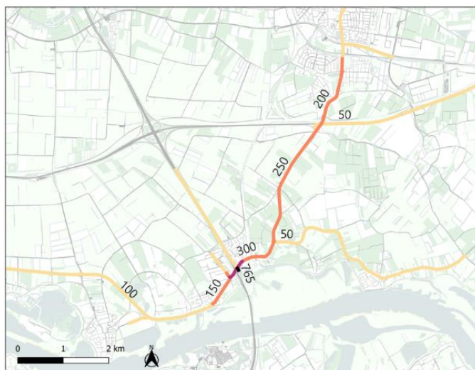
Figuur 2.2: Voorbeeld van een selected link analyse op basis van TomTom FCD, waarbij de percentages zijn omgezet in aantallen.
